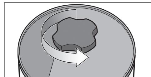
Den Drehknopf 1 bis 2 Umdrehungen gegen den Uhrzeigersinn drehen, bevor Sie den Deckel schließen, um die Entlüftung zu öffnen und den Vakuumdruck abzulassen.
