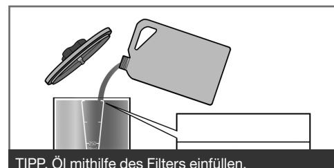
TIPP. Öl mithilfe des Filters einfüllen.
