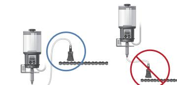
Bei Ölen unterhalb der Viskositätsklasse ISO VG 100, den PLC-OL480 Spender unter die Schmierpunkte anbringen und die Schlauchleitung mehrmals einwickeln, um ein Austreten von Öl durch Schwerkraft zu vermeiden.
