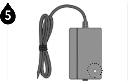
Stellen Sie sicher, dass die rote LED des VAC-Adapters (VDC-Wandlers) nach dem Einschalten blinkt.
