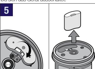
Drücken Sie das Batteriepack herunter und drehen Sie den Clip nach rechts. Entfernen Sie das Batteriepack.
