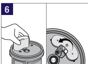
Setzen Sie das neue Batteriepack ein und drehen Sie den Clip nach links um es zu sichern.
