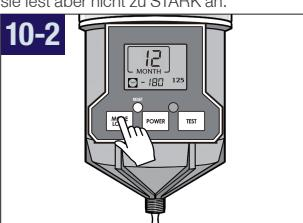
Zum Ändern von Spendezeiten: Halten Sie die MODE-Taste gedrückt bis das Schloss-Symbol verschwindet und drücken Sie dann erneut die MODUS-Taste um die ESpendezeit zu ändern.
