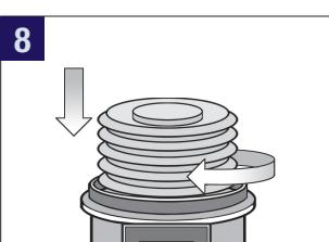
Bringen Sie den neuen Fettbeutel an. Achten Sie darauf, dass sie gerade und nicht verkantet eingesetzt wird. Ziehen Sie sie fest aber nicht zu STARK an.
