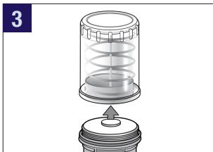
Entfernen Sie das Gehäuse vom Hauptgerät.
